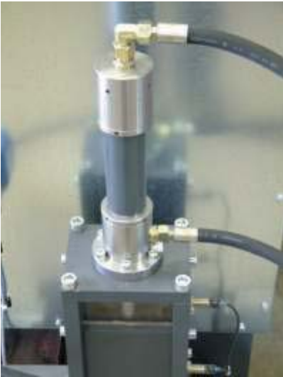
Endlagergedämpfter Füllzylinder und staubdichter Füllschacht Filling cylinder with damped end bearing and dust-tight filling shaft.
