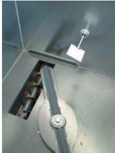
Rührwerk, Förderschneckenvorverdichter und Füllstandsmelder im Inneren Agitator, conveyor worm supercharger and level sensor inside
